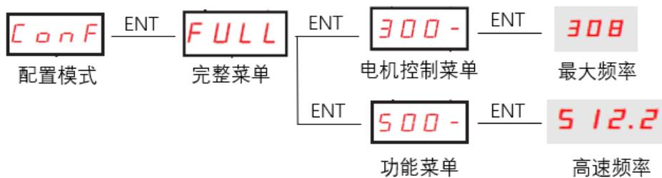
注意：设置超频运行时，请先与电机生产厂商确认，该电机能否超频运行，超频运行时，电机力矩会降低，不正确的使用超频功能可能会导致电机损坏以及负载设备无法正常运行。
