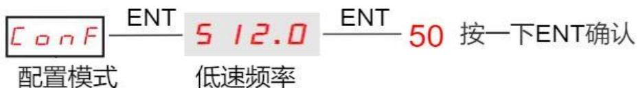
401【给定通道 1】设置为 01“模拟终端”（AI1 模拟量端口调频率）：
