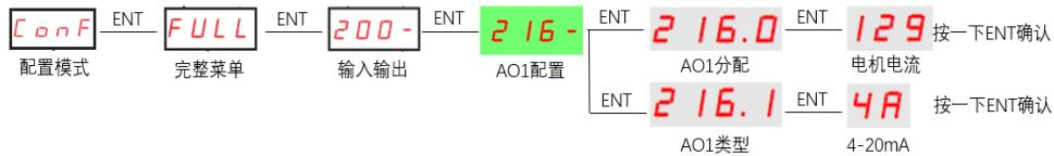
注意：AO1 作为电机电流信号输出时，量程范围默认对应 0-2 倍变频器额定电流(变频器铭牌上标识有此具体数值)，设置上位机量程时应与此量程设置一致。
